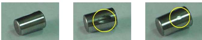
ลูกปินก่อนการทดสอบ ใช้น้ำมันเครื่องทั่วไป เมื่อใช้ผลิตภัณฑ์ EZI
